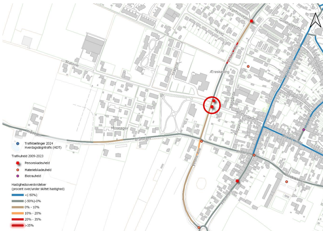
Figur 22. Kort over trafikikkerhedsmæssige forhold ved Vestre Allé i Ærøskøbing. Områder med løsningsforslag, er markeret med rød cirkel.
