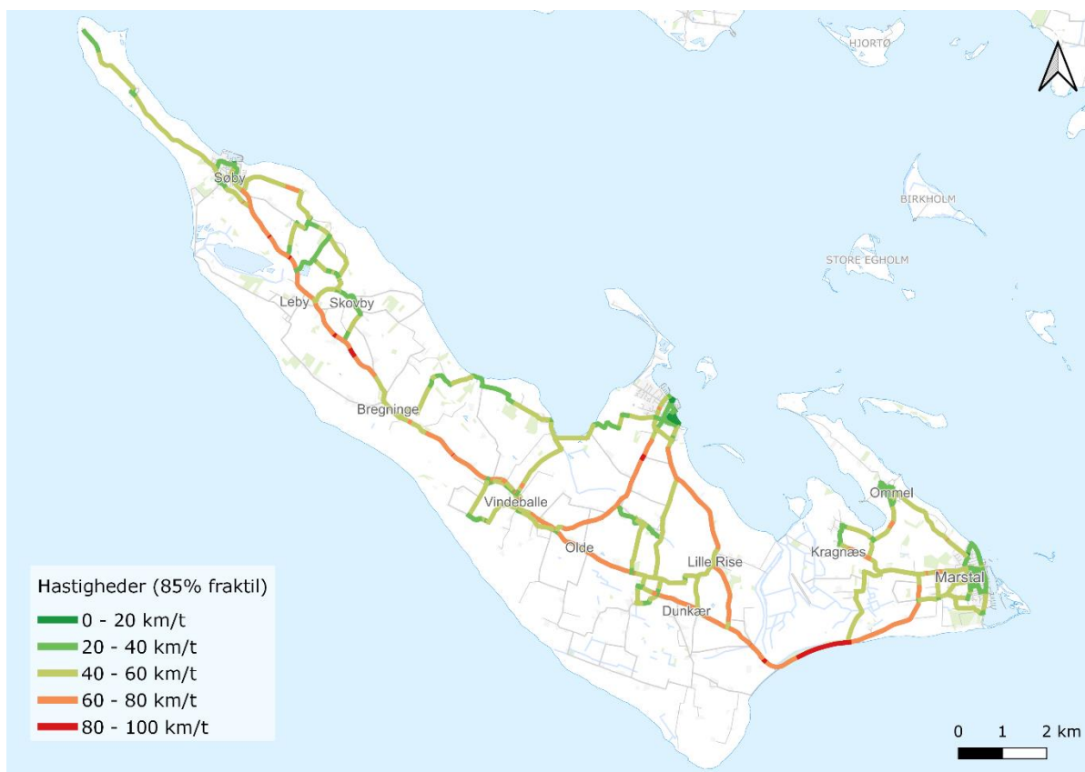
Figur 5. Hastigheder, inddelt i 5 hastighedsgrupper, på det overordnede vejnet i Ærø Kommune. Hastighedsdata er hentet fra TomTom og aggregeret på 85% fraktil-niveau.
